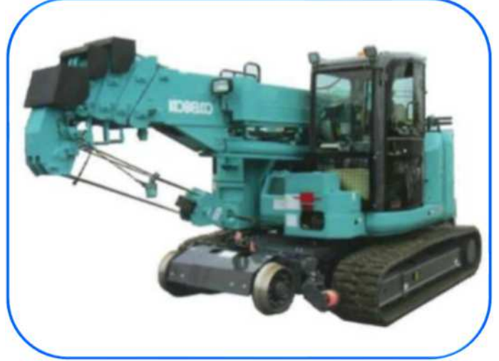
■ 4.9 t クローラークレーン
