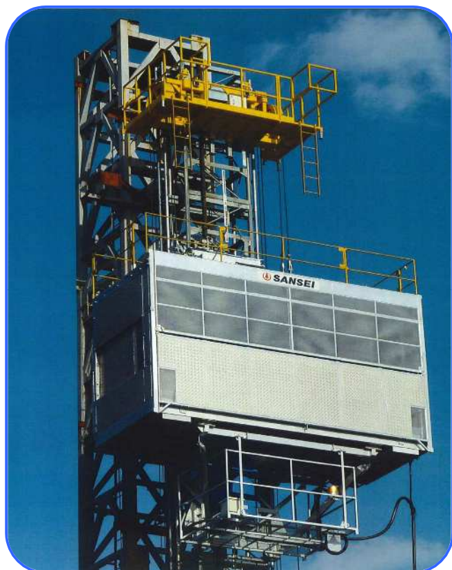
■工事用エレベーター（積載3000 k g）
